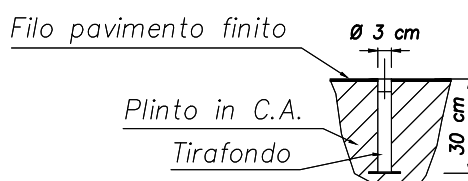
POSIZIONAMENTO TIRAFONDO PAVIMENTO IN APPOGGIO
