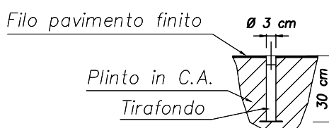
POSIZIONAMENTO TIRAFONDO PAVIMENTO IN APPOGGIO
